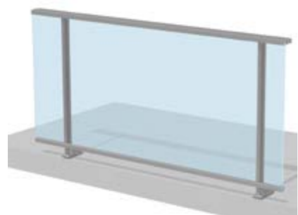
Remplissage verre sous main courante
