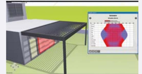
Ensoleillement en façade sud : lames parallèles ouvertes à 130°. En hiver, l'objectif est de capter les rayons solaires.
