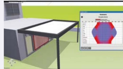
Ombrage en façade sud : lames parallèles fermées. En été, l'objectif est de se protéger des rayons solaires.
