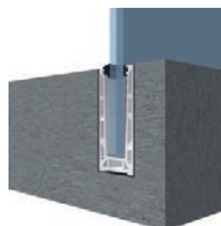
Zócalo en U embutido en el forjado
