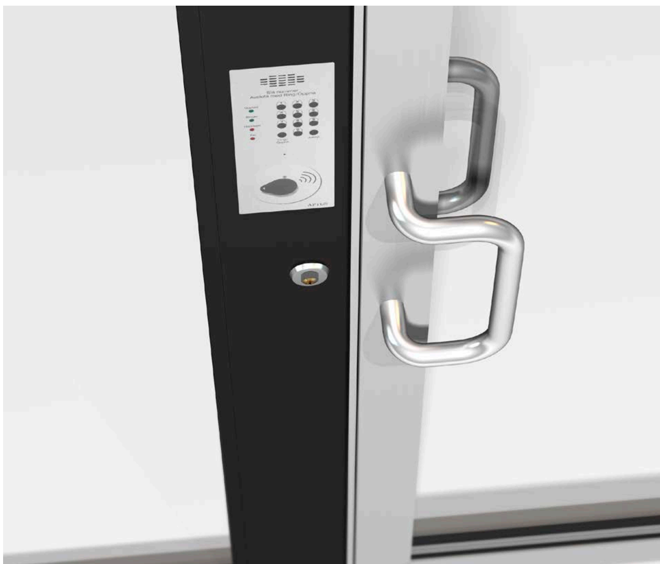
Entré med porttelefon/passersystem. Dörr naturanodiserad och karmar pulverlackerade. Lås monterat i karm. Förstärkt anslagsprofil.
