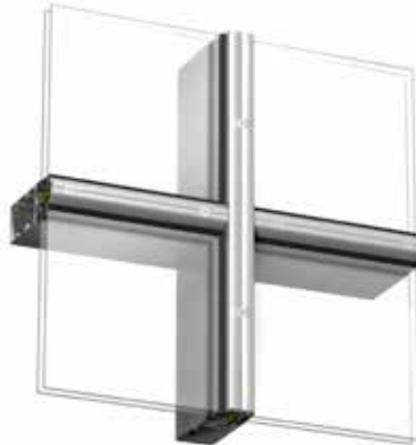
Vaakasuuntainen Optima 42651 yhdistettynä pystysuuntaiseen 42653:een, kiinnitetään ruostumattomalla tai mustaeloksoidulla näkyvällä ruuvilla, k/k 200 mm.
