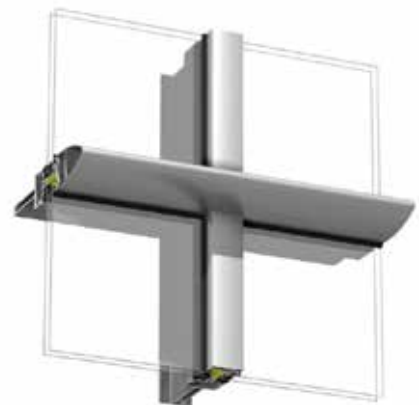
Expressive-pintalistat 68822 yhdistettyinä pystysuuntaisiin 42227-profiileihin.
