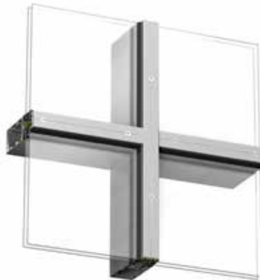
Vaaka- ja pystysuuntainen Optima 42653, kiinnitetään ruostumattomalla tai mustaeloksoidulla näkyvällä ruuvilla, k/k 200 mm.
