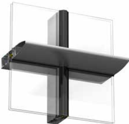
Pystysuuntainen Optima 42844/42845 yhdistettynä vaakasuuntaiseen Expressive 68823:een.
