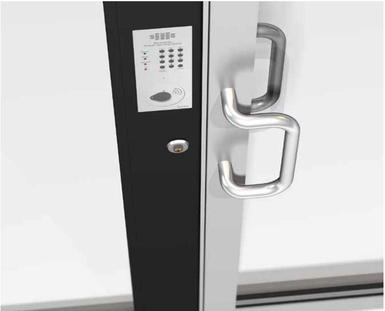
Ovipuhelimella/kulunvalvonnalla varustettu sisäänkäynti. Ovi luonnonanodisoitu ja karmit jauhemaalattu. Lukko asennettu karmiin. Vahvistettu huullosprofiili.
