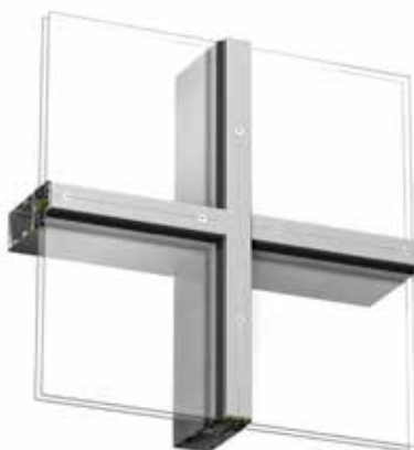
Optima 42653 horisontalt og vertikalt, festes med synlig skrue i rustfri eller i sort utførelse, c/c 200 mm.
