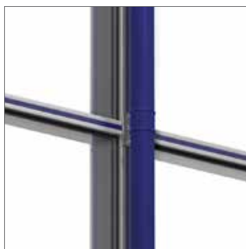
I Add 42693 monteres nedløpsrør og takrenner med tilpassede beslag.
